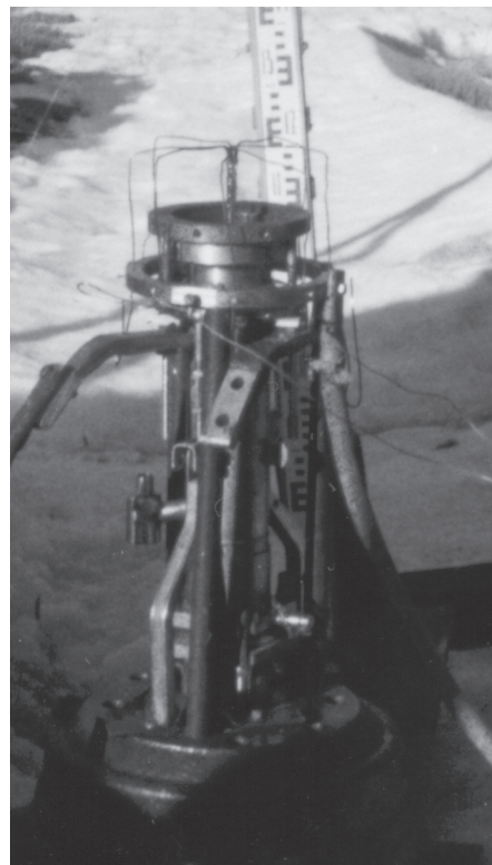
Рис. 2. Фотография устройства для испытания диэлектрических материалов.
