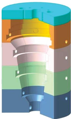
Рис. 2. Огнеупорный бассейн плавителя.
