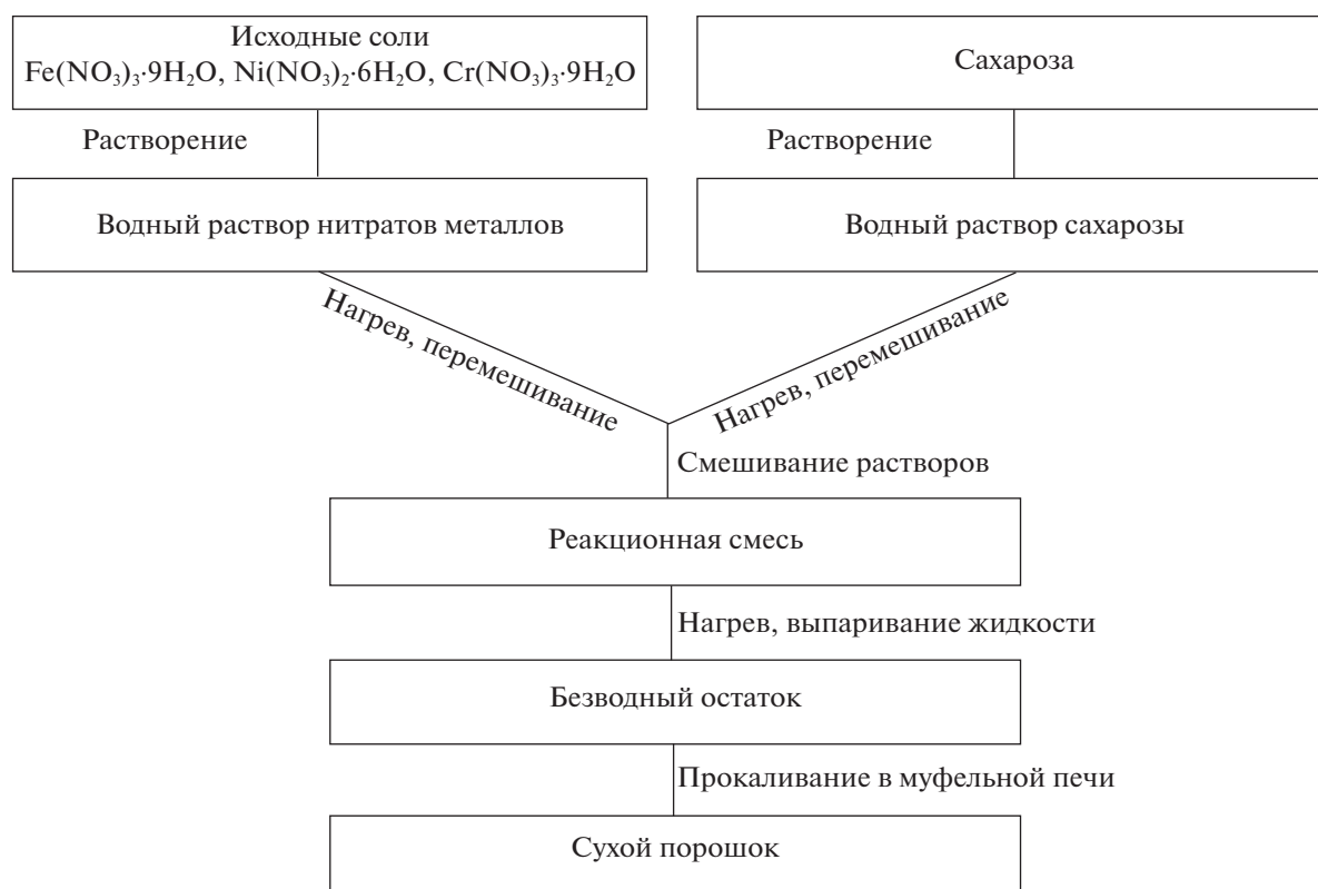
Рис. 1. Схема процесса синтеза \text{NiFe}_{2-x}\text{Cr}_x\text{O}_4 методом автосжигания.
