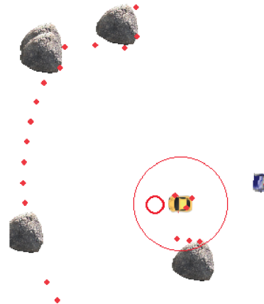
Рис. 3. Визуализация работы лидара. Красными точками отмечены крайние точки по каждому из направлений, которые не закрыты препятствием.
