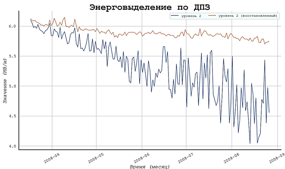
Рис. 7. Восстановленные показания вышедшего из строя датчика
