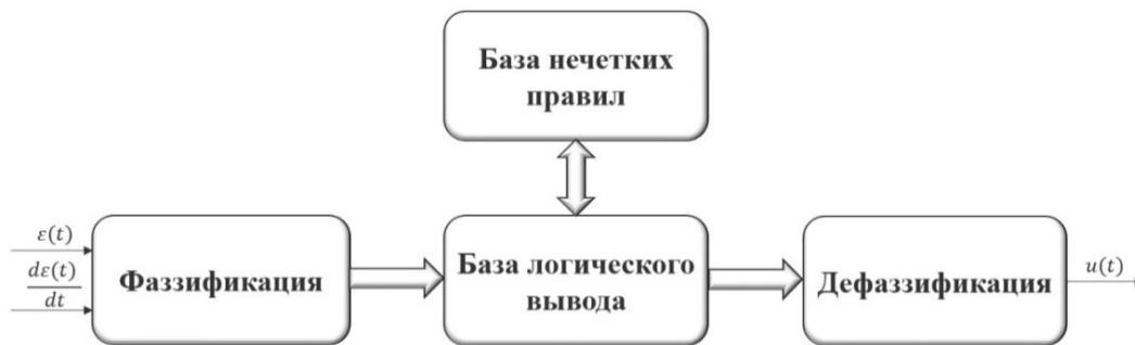
Рис. 3. Структурная схема нечеткого регулятора
