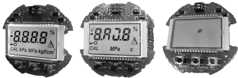
Рис. 2. Модули, прошедшие некачественный контроль
