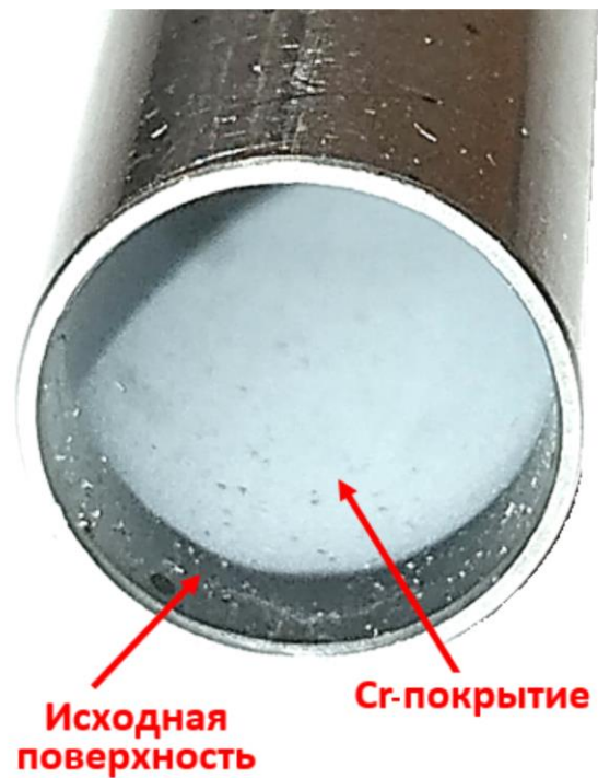
Рис. 3. Фрагменты оболочки твэла с хромовым покрытием на внутренней поверхности
