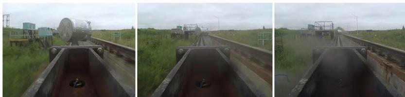
Рис. 9. Кадры разгона и отделения ТУК от ракетного поезда, снятые камерой с борта.
