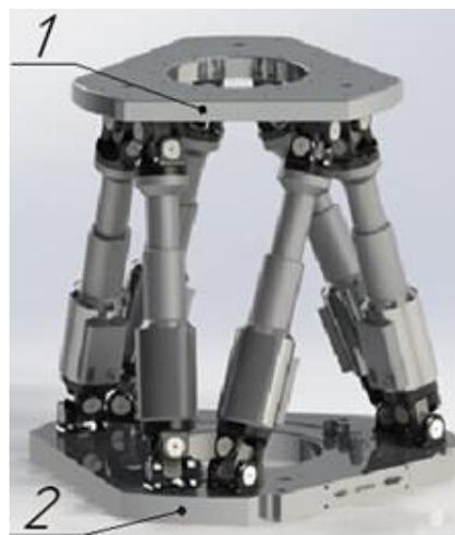
Рис. 2. 3D-модель динамической платформы подвижности в Solidworks
