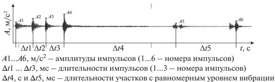
Рис. 2. Параметры портрета срабатывания фиксатора.
