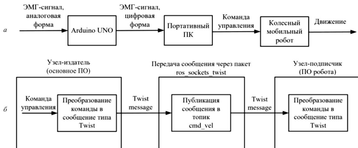
Рис. 1. Схемы взаимодействия: а) аппаратных модулей; б) управляющего ПО и ПО робота
