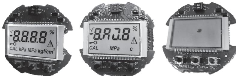
Рис. 2. Модули, прошедшие некачественный контроль
