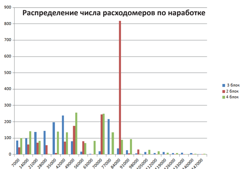
Рис. 2. Распределение числа расходомеров по наработке для разных энергоблоков АЭС с реакторами РБМК
