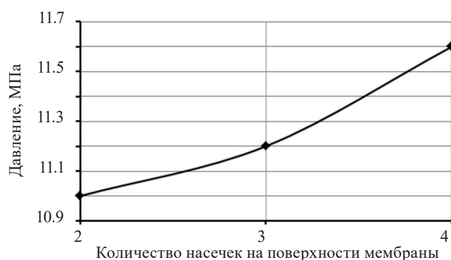
Рис. 8. Зависимость давления раскрытия мембраны от количества насечек
